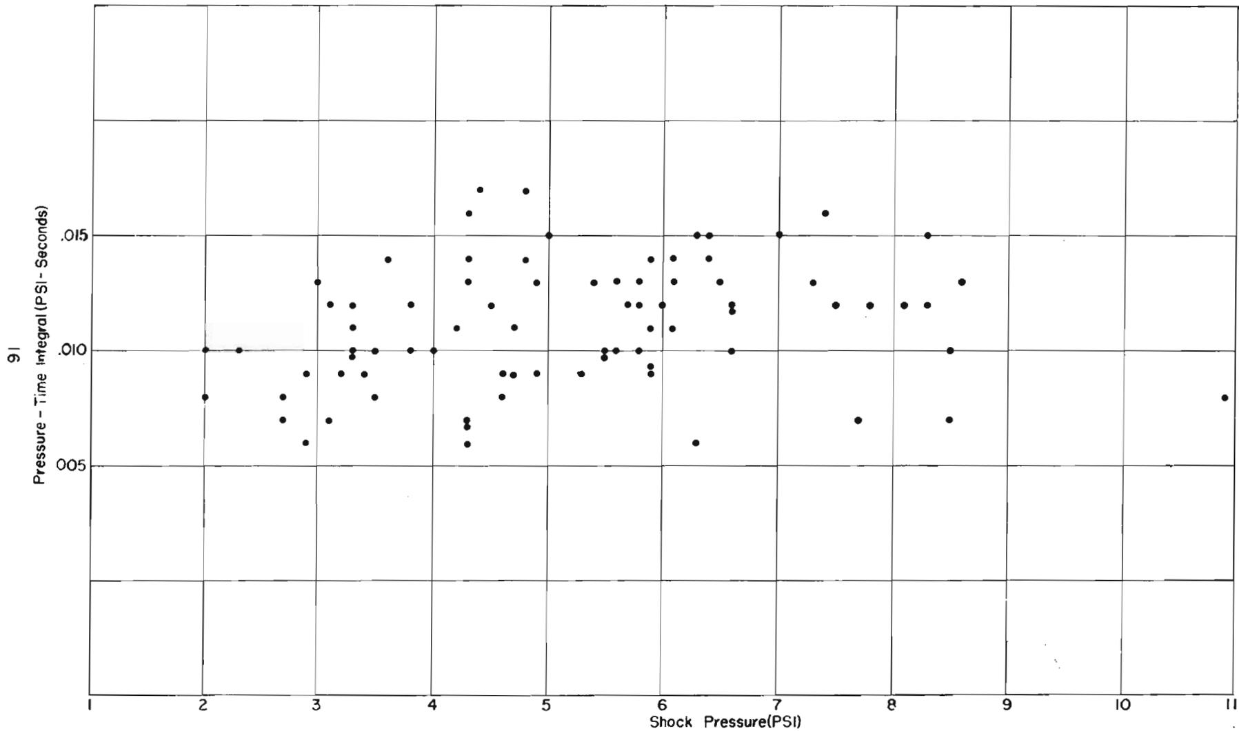
FIGURE 9 RELATION OF SHOCK PRESSURE TO THE TIME-INTEGRAL OF THE PRESSURE
