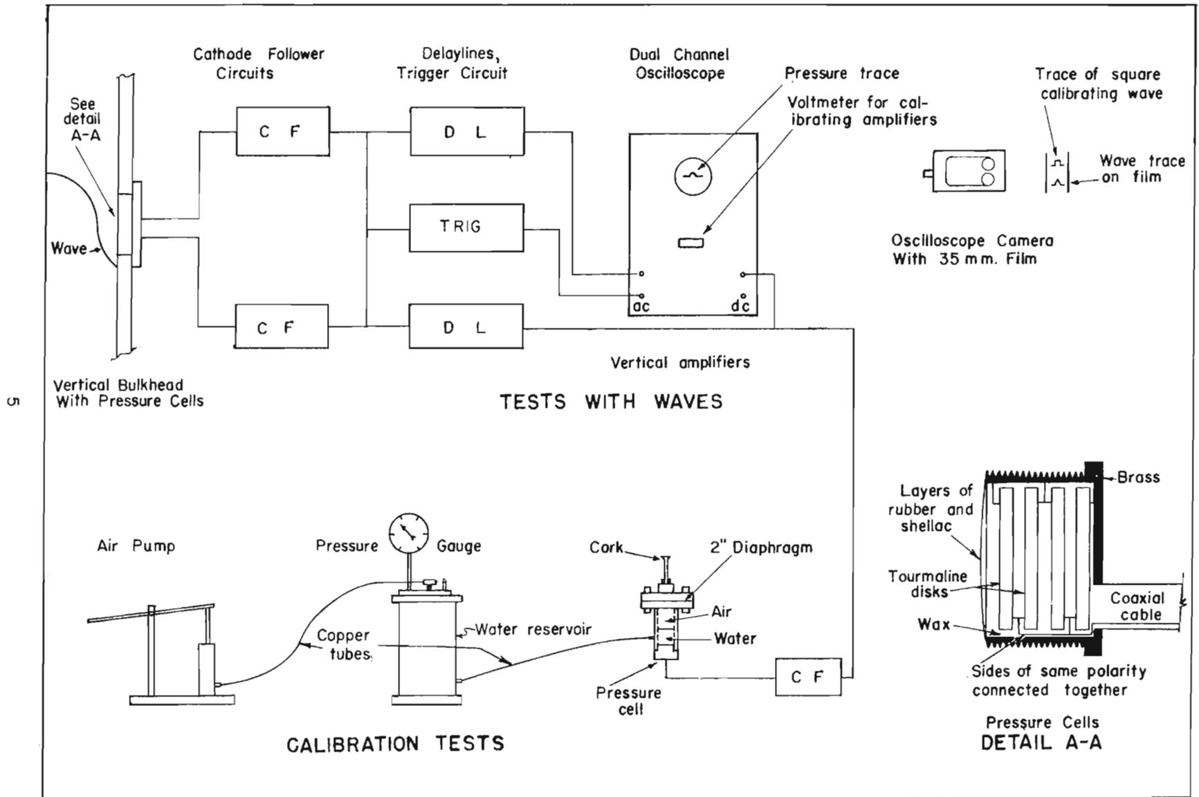
FIGURE 2 · PATH OF SIGNAL FOR WAVE AND CALIBRATION TESTS
