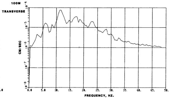
TEST 33 6HZ SINE WAVE TONE BURST
