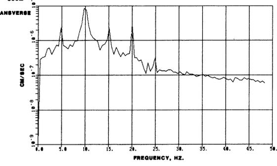
TEST 70 5HZ DISCRETE FREQUENCY SINE WAVE
