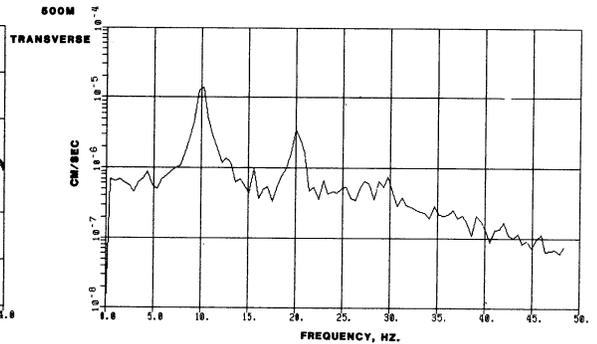
TEST 65 10HZ SINE WAVE TONE BURST
