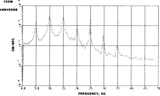
TEST 10 5HZ DISCRETE FREQUENCY SINE WAVE
